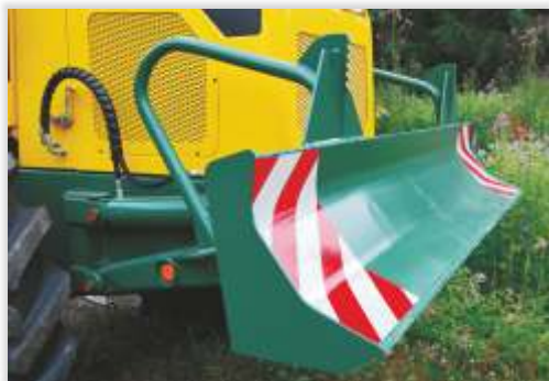
zadný štít - rear log arch - sztyld tylny
